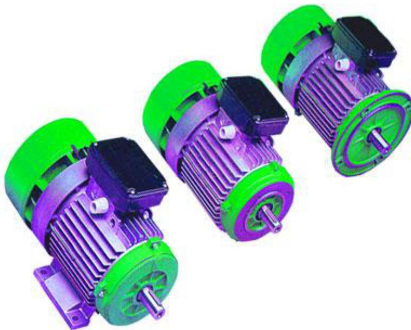
I motori **ULKA** di tutte le serie, sia monofase che trifase, sono disponibili nella versione “autofrenante”. In questo caso, il motore è dotato, posteriormente, di un gruppo freno elettromagnetico a pressione di molle ad azione negativa, che permette sia l’arresto pressochè istantaneo del rotore sia lo stazionamento dello stesso.
